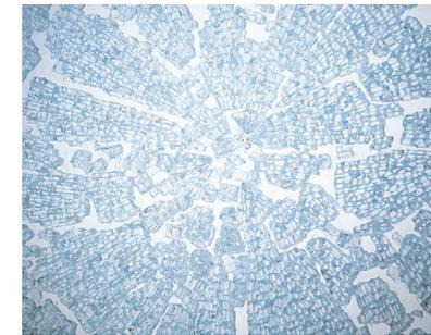
■強化ガラスの破壊形状
